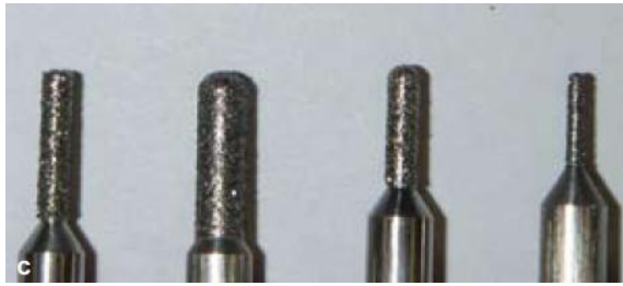
Fig. 4-1-52-a,b,c The milling tools for CAD/CAM a. Dental Cadim 107 D b. Cercon c. GN-I
